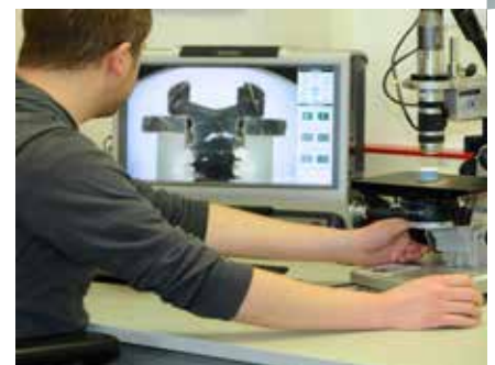
Makroskopische Beurteilung einer Schraube im Längsschliff
