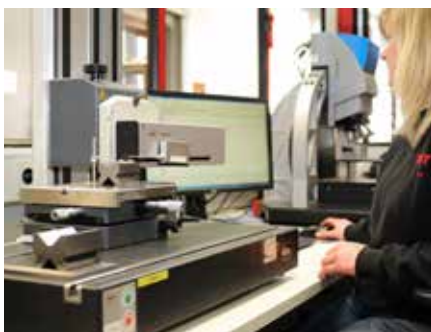
Taktile Rautiefenmessung zur Vermessung von Werkzeugen und Artikeln
